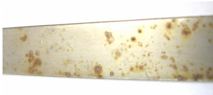
Figura 4- Corrosão por pites em aço inoxidável AISI 420 após 24 horas de exposição em soro fisiológico.
